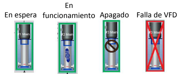
Figura 5.1.7. Estado de bomba
